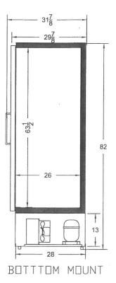
Conçu pour un fonctionnement à une température ambiante de 75°F et à 55% d'humidité relative. Spécifications sujettes à changements sans préavis. (Rev. 23-10-2020)
